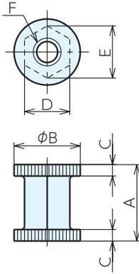
材質 エンジニアリングプラスチック(PBT樹脂)
