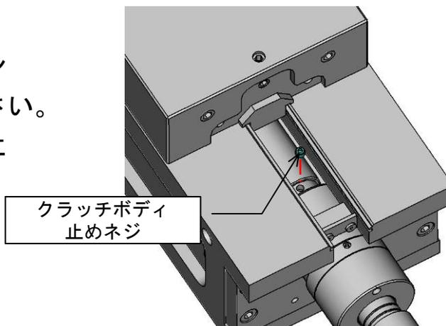
4. ハンドルを差し込み、19mm 六角レンチをシリンダーカバーに差し込んだまま回らない様に固定した状態で、ハンドルを左に回しますとクラッチボディユニットのみ回りますので外して下さい。
