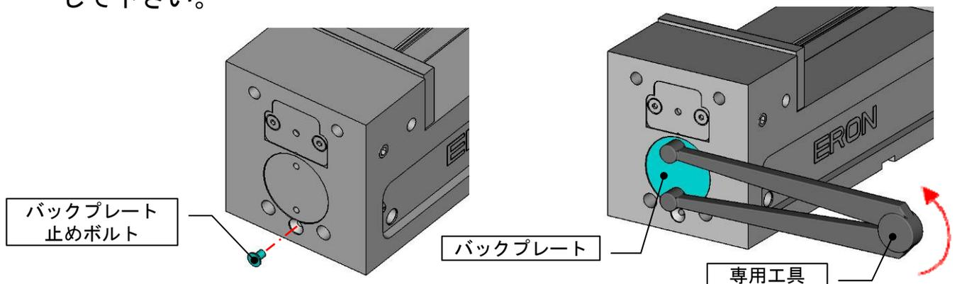
3. クラッチボディ止めネジをハンドルを回して2カ所外して下さい。
