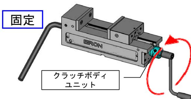
5. 可動体を固定側に移動させると、スピンドルユニットが飛び出しますので、回して外して下さい。スピンドルを回して抜きが重い場合は、調整ネジ押しネジを緩め、調整ネジを緩めて下さい。
