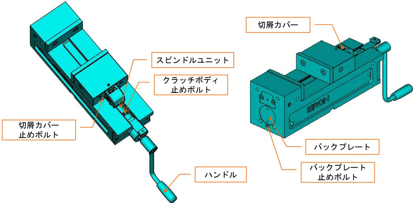
1. 切屑カバー止めボルトを外して、切屑カバーを外して下さい。
