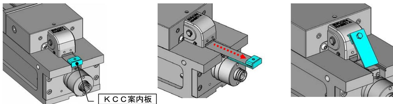
5. 収納ボックス止めボルトを外し、可動体側用切屑カバーユニットを外してください。
