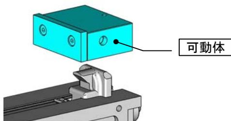
9. メネジに取付けられている切屑カバー止めボルトを外し、切屑カバーを収縮してください。
