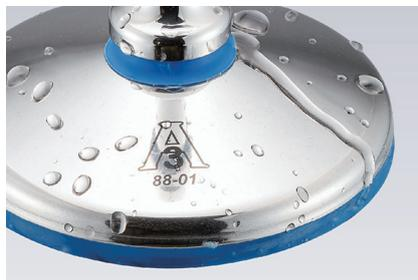
ベース表面は Ra0.8 以下の面粗さで緩やかな傾斜とコーナー処理が施してあるため、洗浄液や水・汚れがフロアに流れ落ちます。
