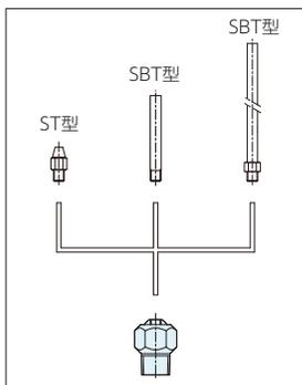
ノズル先端がネジ式 (E寸法) は、スプレーチップやチューブを取り付けることができます。
