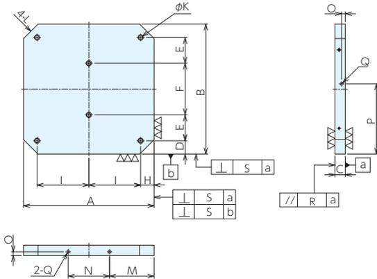
本図はMC400P050PからMC500P090Pの取付穴位置を示し、MC630P050PからMC800P110Pは右図に示します。
